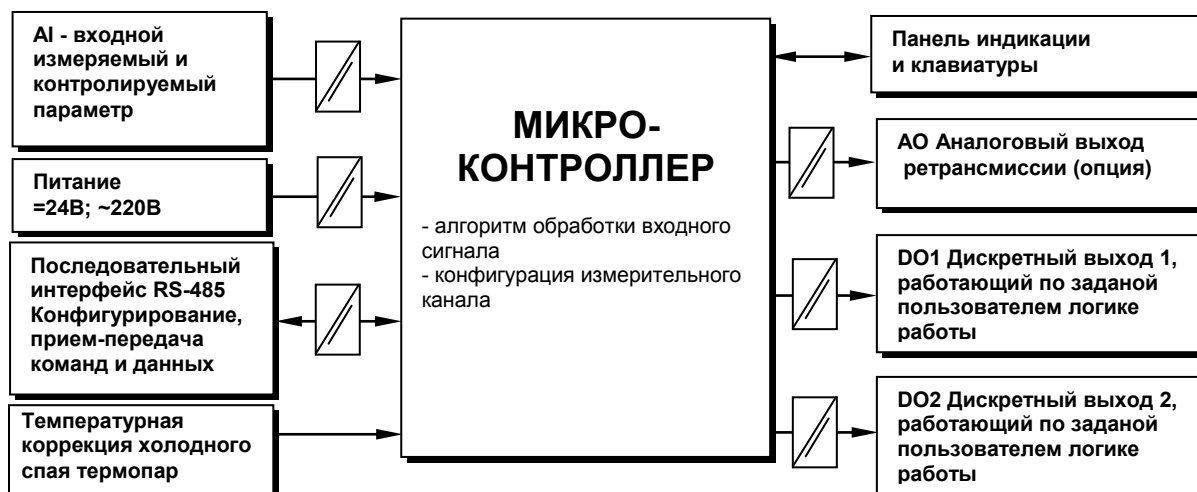
Рисунок 3.2 - Структурная схема индикаторов ИТМ-111, ИТМ-111В
